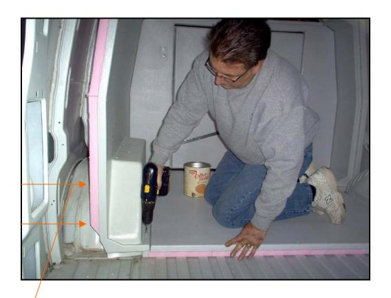
INSTALL TIP - BACK OF PANEL SHOULD BE PUSHED BY SECOND INSTALLER WHEN FIRST INSTALLER IS DRILLING HOLES FOR SCREWS TO ENSURE TIGHT JOINTS.
